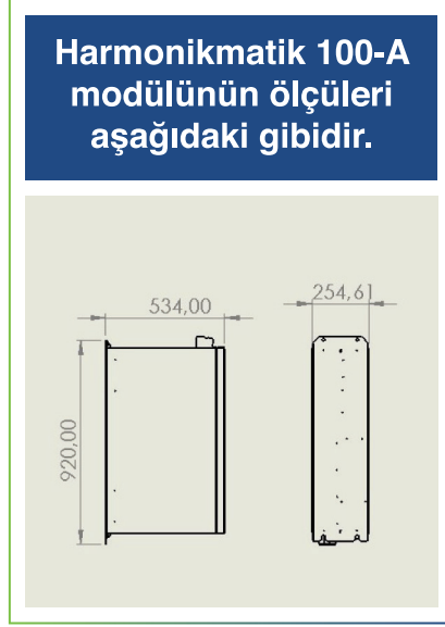
Harmonikmatik AHF Modülünün Ağırlığı 60 kg'dır
