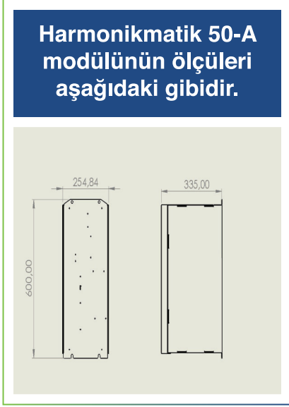
Harmonikmatik AHF Modülünün Ağırlığı 28 kg'dır
